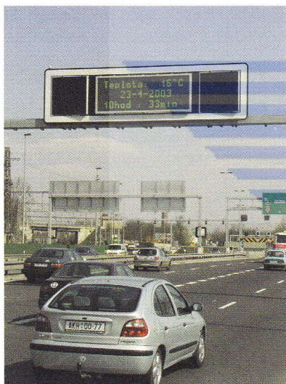
Obr. 3-19: Třířádková informační tabule na vjezdu do tunelu
